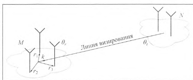
Рис. 2. Линия визирования передатчик–приемник
