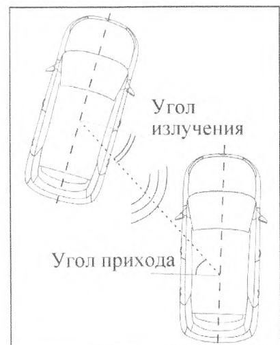
Рис. 1. Конфигурация взаимных угловых измерений
